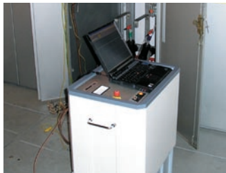
Fig. 7: Configurația CDS pentru o măsurătoare în teren
