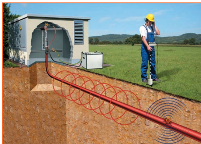
Localizarea defectului cu SWG și Digiphone Plus
